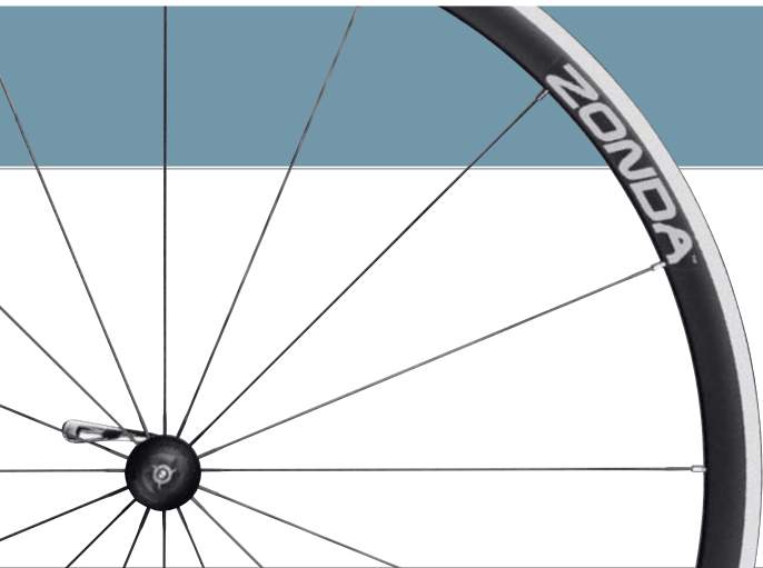
Roue avant avec rayonnage radial
