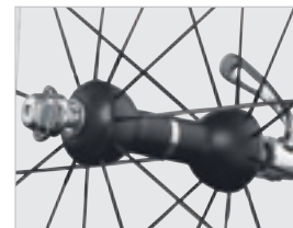
Vorderradnabe der Record Klasse
