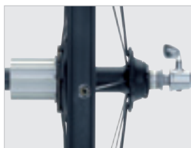
Asymmetrisches Hinterrad für eine ausgeglichene Winkelstellung der Speichen zur Nabenmitte
