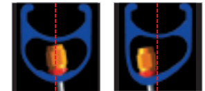
Vorderrad mit symmetrischem Felgenprofil
