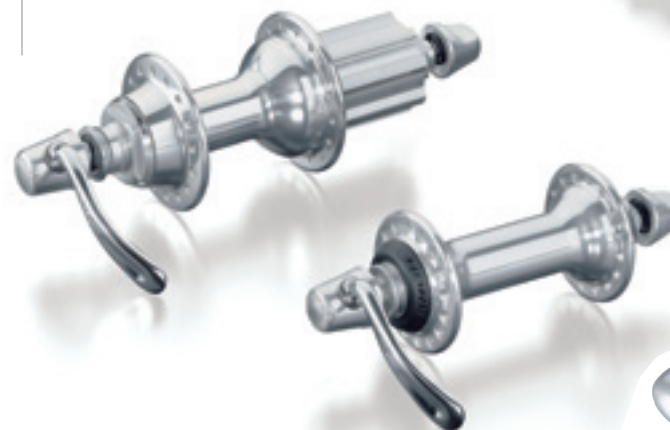
Chorus Naben: Oversize-Nabenkörper und Nabenachse aus Aluminium mit einstellbaren Kugellagern
