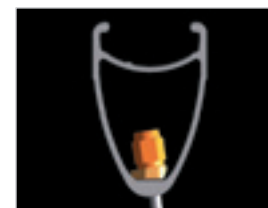
Sistema tuerca-arandela de auto-orientación que garantiza una distribución optimizada de las cargas
