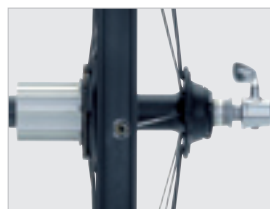
Rueda trasera asimétrica para un ángulo de caída más equilibrado
