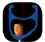
Hinterrad mit asymmetrischem Felgenprofil
